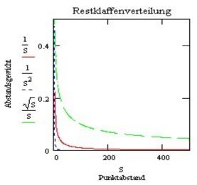
Die vorgenannten Methoden können mit einem <u>Interpolationsradius</u> kombiniert werden. Die <u>multiquadratische Verteilung</u> liefert auch dann gute Resultate, wenn die Passpunkt in unregelmäßiger Punktdichte vorliegen und die Klaffungen in Betrag und Richtung stark wechseln.
