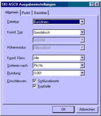
Aktivieren Sie die Seite Basislinie, dort aktivieren Sie Kovarianz, Antennenhöhen und SKI 2 kompatibel. Mit diesen Einstellungen können Sie dann die gewünschte ASCII Datei erzeugen und anschließend in das PAGE Format umsetzen.
