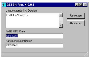
Die mit SKI erzeugten Vektoren werden von SKI in eine Textdatei geschrieben die in das PAGE Format umgewandelt wird. Aus der Textdatei wird eine Datei mit GPS-Vektoren und eine Datei mit kartesischen Punktwerten erzeugt. Die Umsetzung bietet außerdem die Möglichkeit Fehler in der Antennenhöhenmessung zu korrigieren. Mit der aktuellen SKI Pro Version können Fehler in Antennenhöhe oder Punktnummer im Programm editiert werden.
