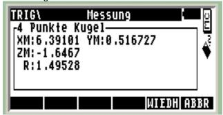
Der Kugelradius (Reflektorhöhe) wird aus den ersten vier Messungen berechnet und wird zur Kontrolle angezeigt. Die Reflektorspitze (Kugelmittelpunkt wird anschließend in einer Ausgleichung mit der eingegebenen Reflektorhöhe berechnet.
