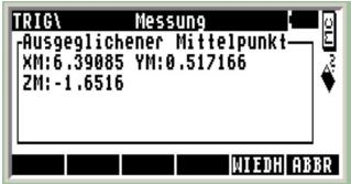
Die Berechnung wird in Protokolldatei (<Projekt>.TXT) protokolliert. Als Beobachtungen werden die Polarkoordinaten der ausgeglichenen Reflektorspitze gespeichert
